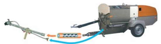
**Geeignet für Putze**, auf Kalk-Zement- oder Kalk-Gips-Basis mit Raumgewichten von 0,3 bis 2,5 t/m<sup>3</sup>, pumpfähige Trockenmörtelsorten wie Grund- oder Kratz-Putze, sackfertige Innen- und Außen-Putze, Körnung je nach Maschinenausführung bis zu 6 mm.
