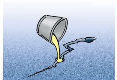
Kleine Risse im Estrich werden alle 20 cm mit einem 15-mm-Bohrer aufgebohrt. In die sauber gereinigten Löcher wird die fertige Masse gegossen oder gespachtelt und dann geglättet.
