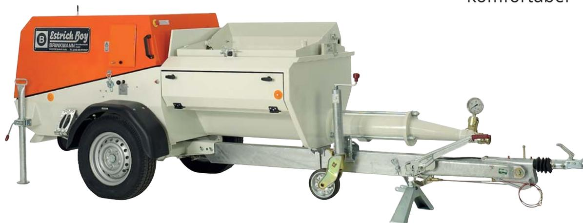
Mit einer Förderleistung von 15 m<sup>3</sup> pro Stunde kann unser Typ FHS 200/3 schon einige Transportbetonfahrzeuge am Tage leer pumpen und den Fließestrich dank seines kräftigen Dieselmotors
