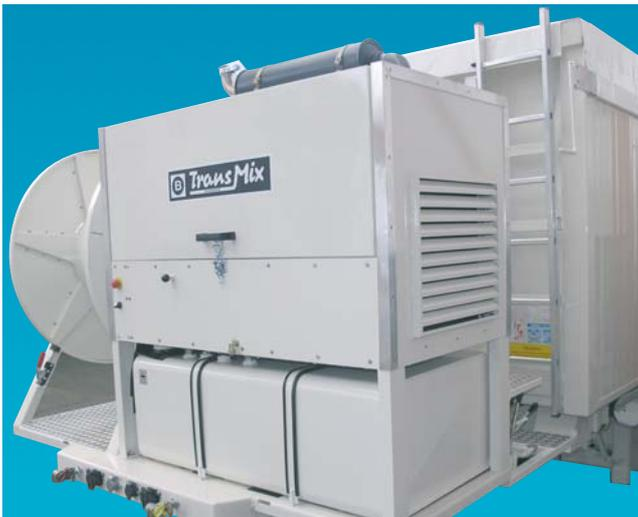
Motor und Hydrauliksystem
