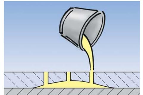
Die hohl liegenden Stellen werden mehrmals mit einem ca. 15-mm-Bohrer bis zum Unterboden durchgebohrt und mit der angerührten Masse ausgegossen. Durch diese Maßnahme beseitigt man das unerwünschte „Klappern“ beim Betreten der Estrichfläche.
