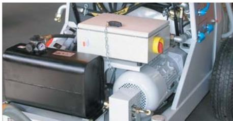
Elektroantrieb mit Schaltkasten
