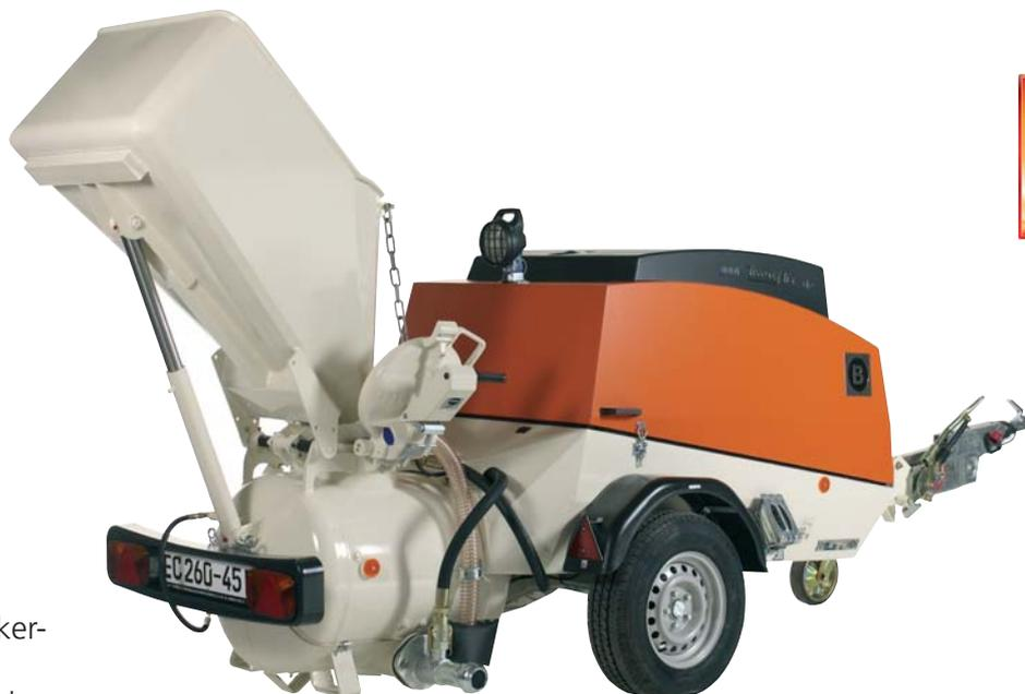
Hydraulisch wird der Beschickerkübel dann zum Entleeren des Inhalts in den Mischkessel hochgefahren. Beim Herunterfahren ist der Kübel so geformt, dass der Sand weggeschoben wird und sich nicht zu einem störenden Haufen aufbauen kann.
