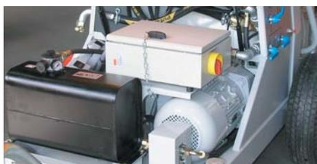
Elektroantrieb mit Schaltkasten
