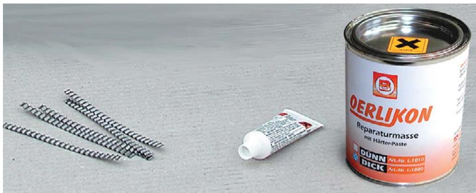
besteht aus einer Epoxidharz-Basis, Quarzmehl und Quarzsand. Es eignet sich besonders für größere Risse im Estrich. Diese entstehen häufig durch Spannungen, die während der Trocknung des Estrichmörtels auftreten. Bewegungen an den Rissen können Beschädigungen an dem Oberbelag verursachen. Besonders kritisch ist dies für die nachfolgende Verlegung mit Fliesen. Entstandene Risse müssen des-
