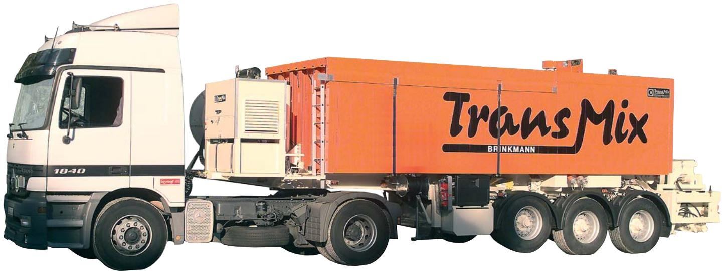
Der SAT FL stellt eine Zwei-Kammer-Siloanlage auf Rädern, kombiniert mit einem leistungsfähigen Schneckenförderer dar. Die Anlage arbeitet vollautomatisch verriegelnd. Dabei haben Sie alles an Bord, was Sie für die Estrich-erzeugung benötigen, nur ein Wasseranschluss ist auf der Bau-stelle nötig.
