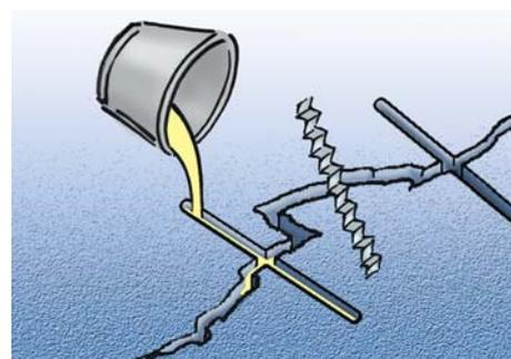
Zur besseren Aufnahme der angerührten Masse werden die Risse zunächst gesäubert. Mit einem Winkelschleifer werden Querschlitzte eingeschnitten. In diese Schlitzte werden Estrichklammern eingesetzt und versenkt. Mit Hilfe der Estrichklammern in Verbindung mit **OERLIKON-DICK** werden die Estrichrisse dauerhaft verbunden.
