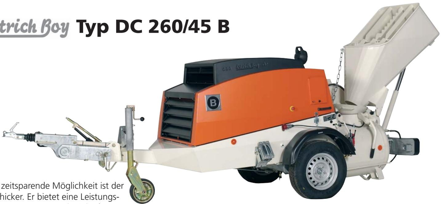
Eine zeitsparende Möglichkeit ist der Beschicker. Er bietet eine Leistungssteigerung um etwa ein Drittel. Während eine Mischung gepumpt wird, kann der Beschicker bereits wieder mit Zuschlag befüllt werden. An einem Arbeitstag können mehr
