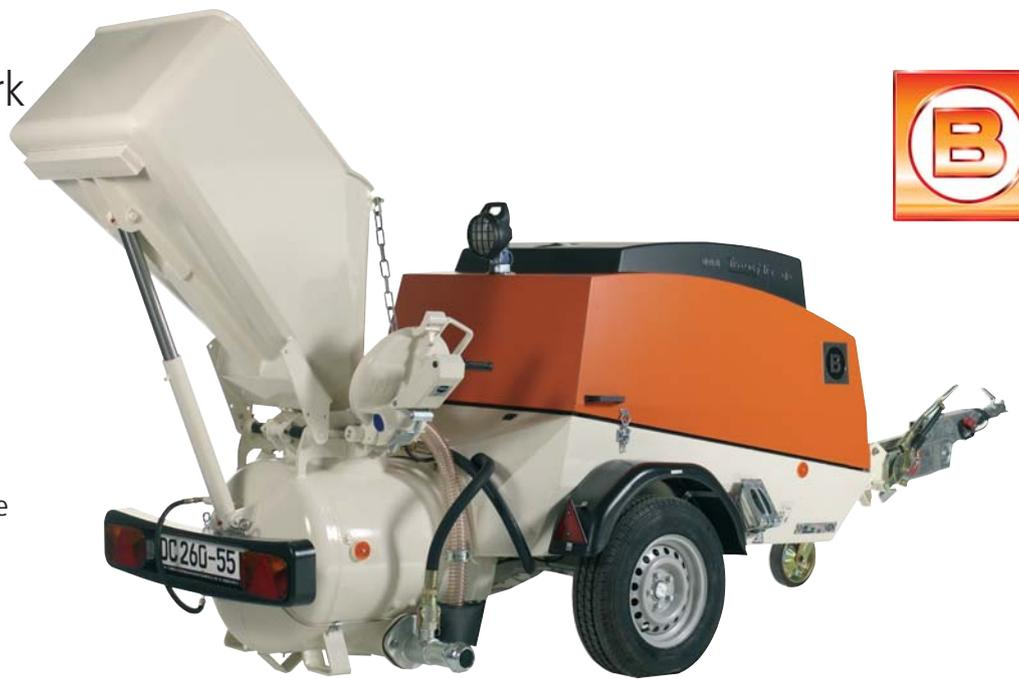
Ein Beschicker bietet Ihnen diese niedrige Befülltiefe. Hydraulisch wird der Beschickerkübel dann zum Entleeren des Inhalts in den Mischkessel hochgefahren. Beim Herunterfahren ist der Kübel so geformt, dass der Sand weggeschoben wird und sich nicht zu einem störenden Haufen aufbauen kann. Das Bindemittel in
