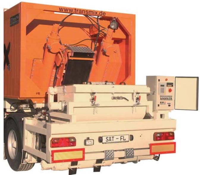
Der Trans Mix stellt eine Zwei-Kammer-Siloanlage auf Rädern, kombiniert mit einem leistungsfähigen Schneckenförderer dar. Die Anlage arbeitet vollautomatisch verriegelnd.
