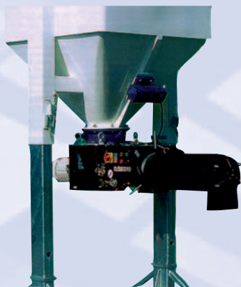
m-tec Gigamix, kontinuální míchačka o vysokém výkonu na betony vysokých pevností
