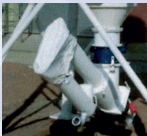
m-tec beton dragon, jednotka na zpracování stříkaných betonů
